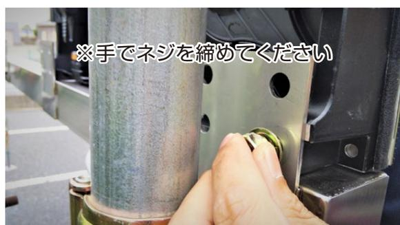
9. 3.で仮止めしたネジを本締めしていきます。
